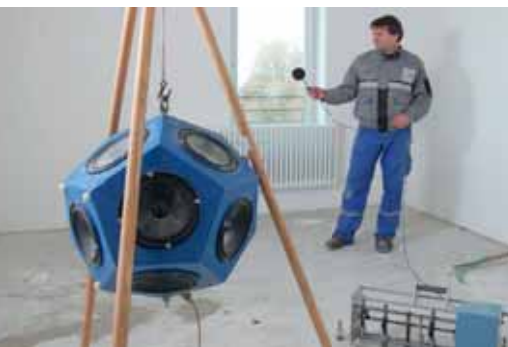
Schallschutzmessung der Decke
