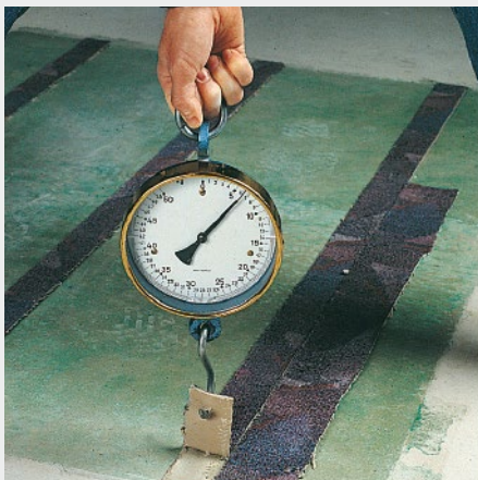
Probeverklebung und Prüfung des Schälwiderstands
