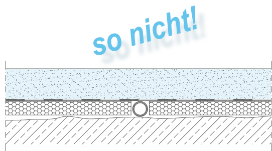
Trittschalldämmung unterbrochen, Kontakt Estrich - Untergrund
