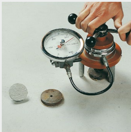
Prüfung der Haftzugfestigkeit
