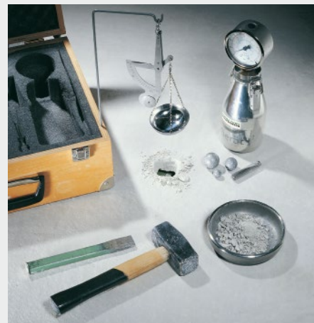
Prüfen auf Belegreife mit dem CM-Gerät
