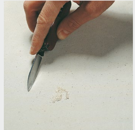
Prüfung des Kornaufbaus
