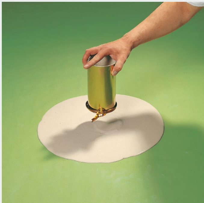
Bestimmung des Fließmaßes: Konsistenzprüfdose mit Mörtel füllen und hochziehen
